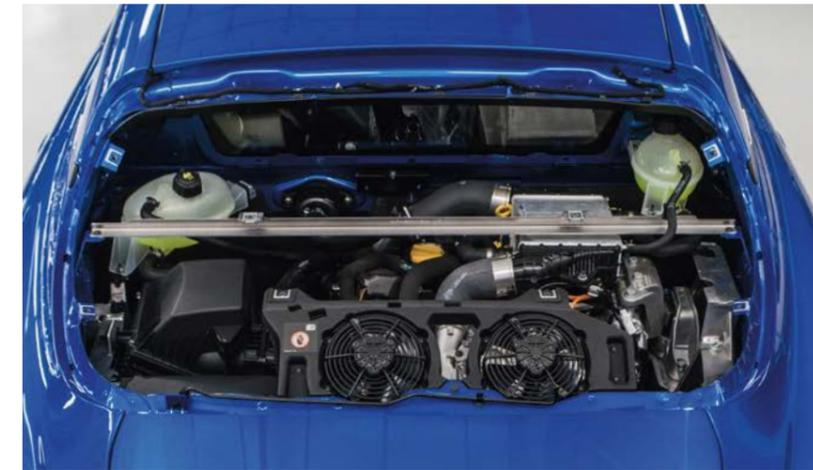
Mis au point par les ingénieurs mécanique Alpine, ce moteur de 1,8 l à injection directe est conçu pour offrir un plaisir immédiat et un niveau de performance élevé. Doté de 300 ch, il délivre un couple généreux disponible de 2 400 à 6 000 tr/min propulsant l'A110 de 0 à 100 km/h en 4,2 secondes seulement et jusqu'à 275 km/h sur circuit.
