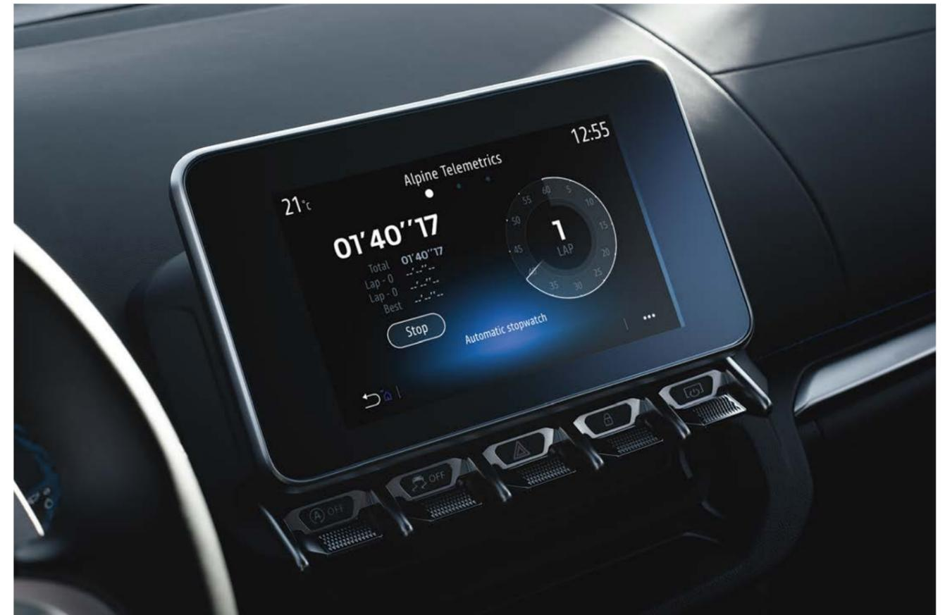
Alpine Telemetrics vous permet d'accéder en temps réel aux données techniques enregistrées par les différents capteurs embarqués de votre A110 (pression du turbo, température de la boîte de vitesses, couple, puissance, angle du volant, accéléromètre, etc.), et de les présenter sous forme de manomètres ou histogrammes intuitifs pour une visualisation immédiate. Le chronographe intégré mesurera et enregistrera vos performances lors des séances sur piste.
